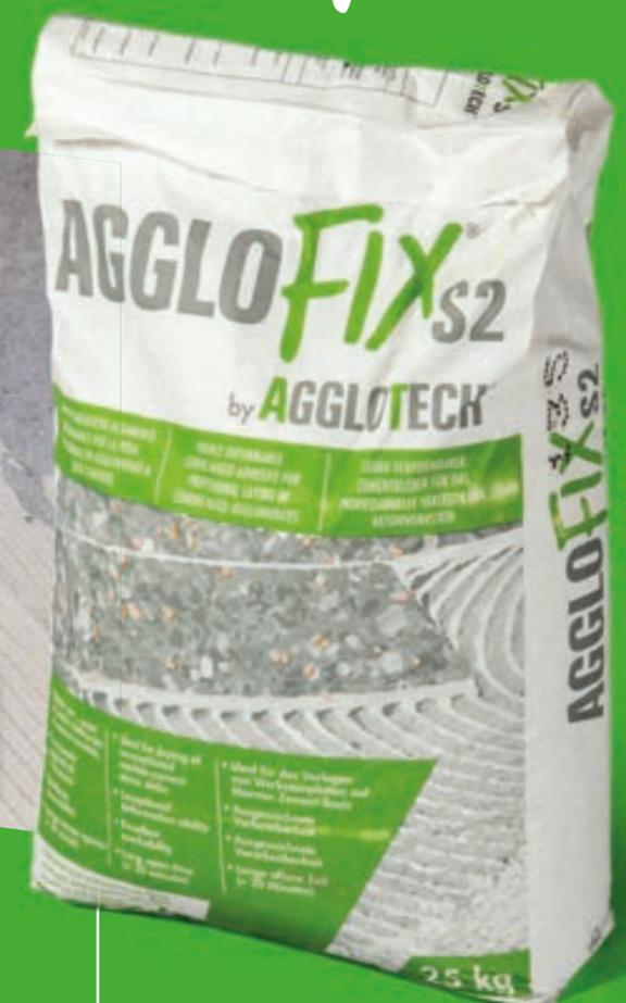
Tecnicamente, AGGLOFIX S2 è un adesivo in polvere di colore bianco a base di cementi ad alta resistenza meccanica, fortemente additivato con resine sintetiche elasticizzanti e additivi speciali che lo rendono altamente deformabile (S2) se sollecitato meccanicamente.
